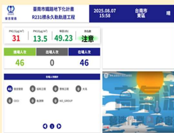
現場設置環境監測系統
