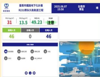
現場設置環境監測系統
