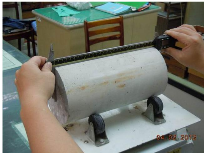
量測試體高度
